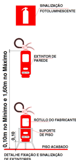
Figura 1. Fixação de extintor
