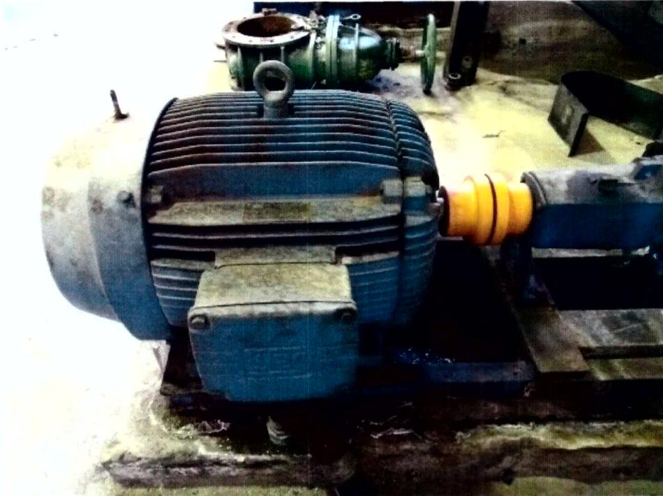
Motor Elétrico marca WEG, 60 CV / 2 polos (3560rpm)
