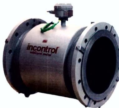
Medidor de vazão magnético marca INCONTROL, modelo VMF para medição da vazão, fabricado com corpo em aço inox e carcaça externa em aço carbono com pintura epóxi. Possui conversor remoto da marca Incontrol. Acondicionado em caixa de alumínio, que indica vazão instantânea e totalização.
